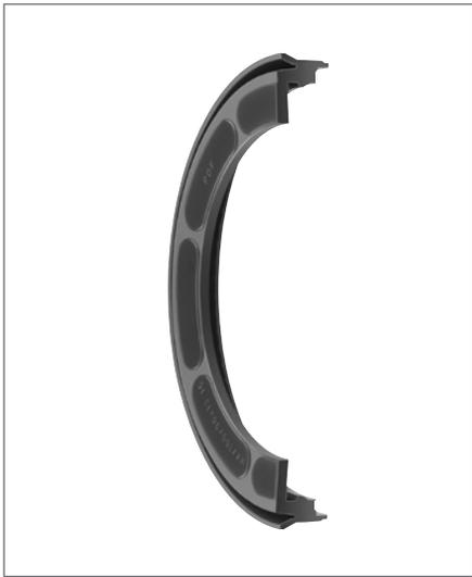
Уплотнение поршня профиля МК из Ultrathan® представляет собой уплотнительный элемент со встроенной направляющей и амортизирующими буферами. Этот уплотнительно-направляющий элемент может быть использован для поршней как с постоянным магнитом, так и без него. При использовании магнитных поршней в уплотнительно-направляющий элемент магнит встраивается внутрь.
