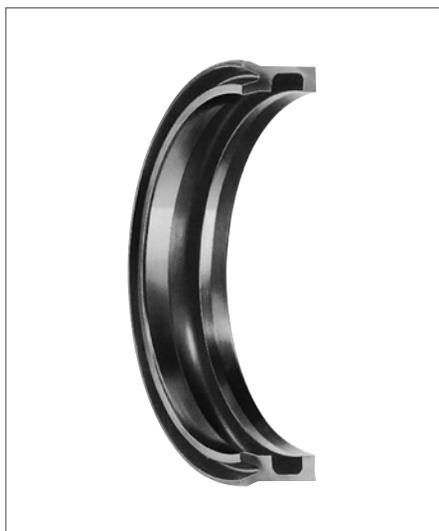
Пневматическое уплотнение поршня профиля Z7 представляет собой U-образное кольцо со встроенной направляющей для поршней одно-стороннего действия.
