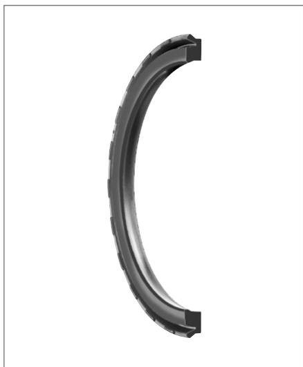
Уплотнение цилиндра профиля Z8 представляет собой уплотнение с уплотнительной кромкой одностороннего действия для поршней в пневматических цилиндрах и клапанах. При этом требуется посадочная канавка небольших размеров. Размеры стандартных серий профиля Z8 соответствуют диаметрам цилиндров по стандартам ISO 3320 и CETOP RP 52 P, RP 43 P и RP 53 P.
