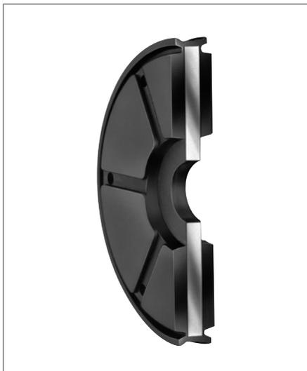
Профиль DP двустороннего действия представляет собой пневматический интегральный поршень в сборе с двойным манжетным уплотнением и опорным завулканизированным металлическим диском, который выполняет одновременно три функции: **уплотняющую, направляющую и амортизирующую.**
