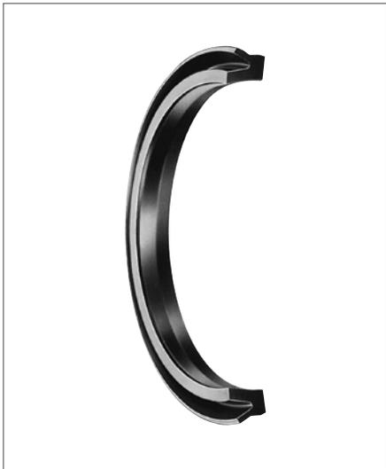
Уплотнение поршня профиля E4 представляет собой манжету с уплотняющей кромкой, специально разработанную для использования в пневматике. Размеры стандартных серий профиля E4 соответствуют диаметрам цилиндров по стандартам ISO 3320, CETOP RP 52 P, RP 43 P и RP 53 P. Профиль E4 полностью взаимозаменяем со стандартными сериями профиля C2, ранее применявшегося в пневматике.
