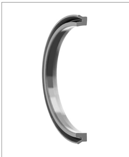
Уплотнение поршня профиля E4 представляет собой манжету с уплотнительной кромкой, специально разработанную для использования в пневматике. Размеры стандартных серий профиля E4 соответствуют диаметрам цилиндров по стандартам ISO 3320, CETOP RP 52 P, RP 43 P и RP 53 P. Профиль E4 полностью взаимозаменяем со стандартными сериями профиля C2, ранее применявшегося в пневматике.
