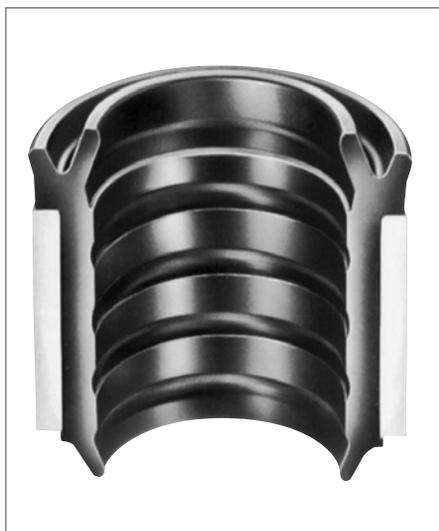
Комбинированный уплотнительный элемент профиля EP манжета/грязесъемник/опорно-направляющая используется для штоков в пневматических цилиндрах и выполняет сразу 3 функции одновременно: **уплотнение, очистка, фиксация.**
