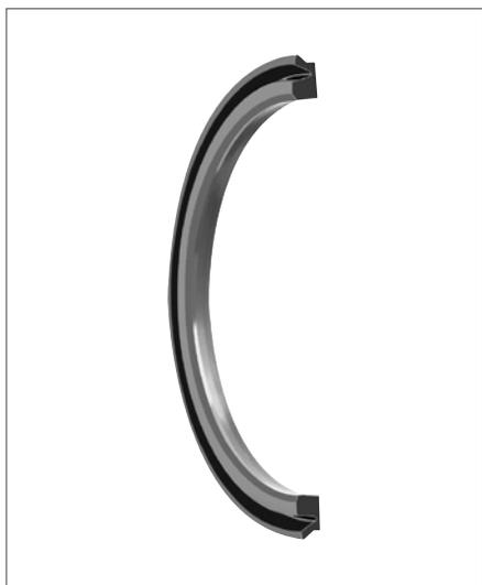
Уплотнение цилиндра профиля Z8 представляет собой манжету с уплотнительной кромкой одностороннего действия для поршней в пневматических цилиндрах и клапанах. При этом требуется посадочные канавки небольших размеров. Типоразмеры стандартных серий профиля Z8 соответствуют диаметрам цилиндров по стандартам ISO 3320 и CETOP RP 52 P, RP 43 P и RP 53 P.
