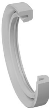
Уплотнение штока HL Ultrathan® — прекрасное решение с оптимированным трением для мобильной и стационарной гидравлики с новым принципом функционирования: это манжета имеет активируемые давлением, каскадно расположенные уплотнительные кромки. Эта конструкция явно уменьшает статическое и динамическое трение в гидравлических цилиндрах и увеличивает эффективность гидравлических систем.
