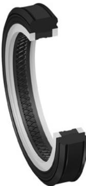
Комплект уплотнений ротора профиля КА состоит из профильного эластомерного уплотнения, армированного тканевой нитью, и двух опорно-защитных колец для увеличения стабильности и предотвращения экструзии в зазор, особенно в случаях с наличием эксцентрикитета.
