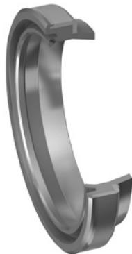
Двойное грязесъемное кольцо Ultrathan® профиля АН используется с целью предотвращения попадания пыли, грязи, песчинок и металлической стружки внутрь гидравлических цилиндров. Это уменьшает риск задирания поверхности, причиной которого являются загрязнители из внешних источников. Прекрасный очищающий эффект достигается благодаря специальной конструкции уплотняющей кромки грязесъемника. К тому же уплотнительная кромка со стороны рабочей среды уменьшает пленку остаточного масла.
