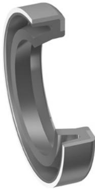
Грязесъемное кольцо Ultrathan® профиля AF применяется с целью предотвращения попадания пыли, грязи, песчинок и металлической стружки внутрь гидравлических цилиндров. Это уменьшает риск задирания поверхности, причиной которого являются загрязнители из внешних источников. Прекрасный очищающий эффект достигается благодаря специальной конструкции уплотняющей кромки грязесъемника.
