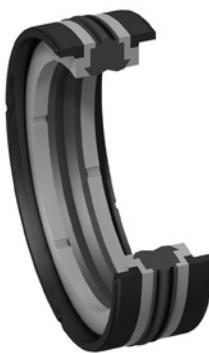
Комплект уплотнений поршня двойного действия профиля ZW состоит из уплотнительного элемента из эластомера, двух анти-экструзионных и двух опорно-направляющих уголообразной формы колец.
