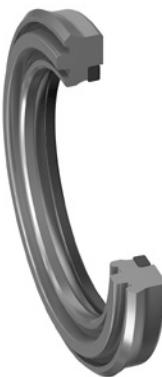
Уплотнение штока Ultrathan® профиля BU — это компактная манжета с интегрированным антиэкструзионным кольцом. Обычное применение уплотнения этого профиля — буферное уплотнение в системах уплотнения гидроцилиндрах строительной техники. Данные цилиндры функционируют в экстремальных условиях, где обычным явлением является давления до 1 000 бар.
