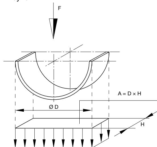
Направляющая лента профиля F3 специально разработана для использования в гидравлических цилиндрах.
