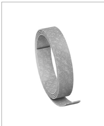
Направляющие ленты FC обладают исключительной износостойкостью и подходят для поршней и штоков. Их можно нарезать любой желаемой длины (макс. 5,5 м). Ленты наматываются на плоские катушки с диаметром сердечника приблизительно 120 мм. Весь ассортимент направляющих лент FC продается расфасованным в рулоны по 5,5 метров (желаемую длину нарезает заказчик.)
