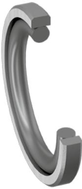
Комплект уплотнений поршня двойного действия профиля OE состоит из уплотнительного кольца поршня из ПТФЭ и кольца круглого сечения из эластомера в качестве силового элемента.
