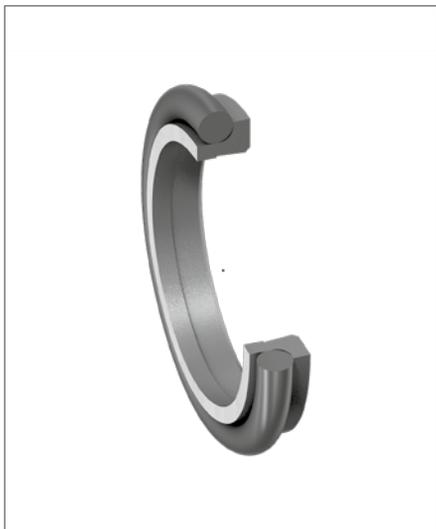
Функция грязесъемных колец заключается в предотвращении проникновения пыли, грязи, песчинок и металлической стружки в аксиально движущиеся штоки и плунжеры. Таким образом значительно снижается возможность появления царапин, защищаются опорно-направляющие элементы и продлевается срок эксплуатации уплотнений.
