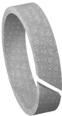
Направляющее кольцо профиля FK открыто и, таким образом, является очень простым для монтажа. Оно исключительно износостойчиво и подходит для направляющих поршней. Использование этого направляющего кольца упрощает конструкцию поршней.
