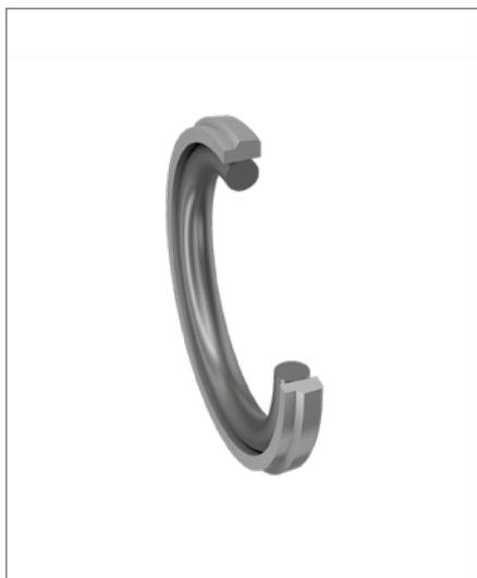
Комплект уплотнений поршня одностороннего действия профиля OG состоит из уплотнительного кольца поршня из ПТФЭ и кольца круглого сечения из эластомера в качестве силового элемента.
