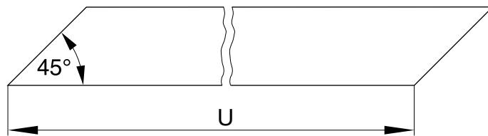
Длина ленты «U» рассчитывается из средней длины окружности за вычетом просвета в соединении «k». Величины k, указанные в таблице, основаны на повышении температуры до 120 °C. (S = толщина направляющей ленты.)
