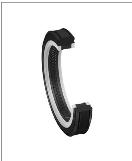
Комплект уплотнений ротора профиля КА состоит из профильного эластомерного уплотнения, армированного тканевой нитью, и двух опорно-защитных колец для увеличения стабильности и предотвращения экструзии в зазор, особенно в случаях с наличием эксцентриситета.
