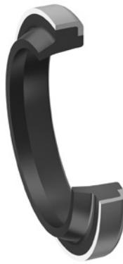
Благодаря специальному профилю грязесъемные кольца профиля AM предотвращают проникновение пыли, грязи, песчинок и металлической стружки. Они также в значительной степени позволяют предотвращать задирание поверхности. Тем самым защищают скользящие поверхности, и продлевают срок эксплуатации уплотнений.
