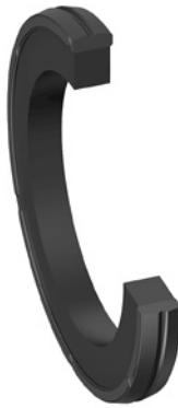
Набор уплотнений поршня Ultrathan® профиля KR дополняет линейку уплотнений поршня двойного действия (ОЕ, ОК) для установки в посадочные канавки в соответствии со стандартами ISO 7425-1 и, которое предпочтительно используется в диапазоне давления до 300 бар. Это уплотнение состоит из профильного кольца из недавно разработанного полиуретана с улучшенными свойствами скольжения и кольца предварительного натяжения с прямоугольным сечением из нитрил-каучукового эластомера.
