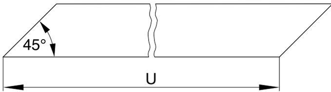
Длина ленты «U» рассчитывается из средней длины окружности за вычетом просвета в соединении «k». Величины k, указанные в таблице, основаны на повышении температуры до 120 °C. (S = толщина направляющей ленты.)
