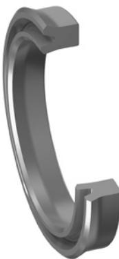
Уплотнение поршня Ultrathan® профиля B7 — манжета с уплотнительной кромкой и плотной посадкой по внутреннему диаметру. Данные уплотнения могут использоваться для любых применений, когда физические свойства обычных или армированных тканью эластомеров являются недостаточными.
