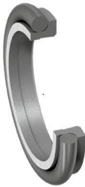
Функция грязесъемных колец заключается в предотвращении проникновения пыли, грязи, песчинок и металлической стружки в аксиально движущиеся штоки и плунжеры. Таким образом значительно снижается возможность появления царапин, защищаются опорно-направляющие элементы и продлевается срок эксплуатации уплотнений.
