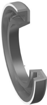
Грязесъемное кольцо Ultrathan® профиля AG используется с целью предотвращения попадания пыли, грязи, песка и металлической стружки в сферические подшипники штокового конца гидравлических цилиндров. Оно уменьшает опасность «съедания» на вертлюжном болте в результате загрязнения из внешних источников. Прекрасный очищающий эффект достигается благодаря специальной конструкции уплотняющей кромки грязесъемника. Более того, эта кромка позволяет вытекать лишней смазке.
