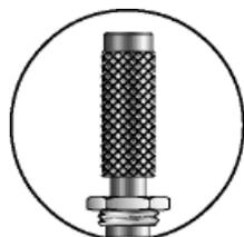
Рукоятка с гофрой (K) обеспечивает легкое регулирование клапана.
