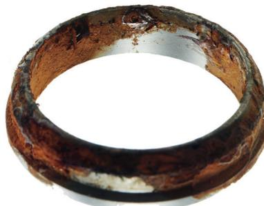
Заднее уплотнительное кольцо, упрочненное азотированием
