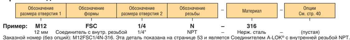
**Обозначение корпуса:** Для обозначения типа фитинга используется буква или комбинация букв и цифр. Обозначение корпуса см. в наглядном содержании на стр.х 36 и 37.
