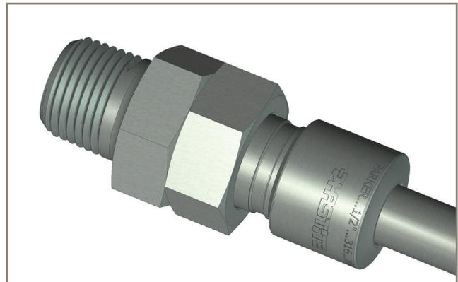
Упорное торцевое сопряжение металла-по-металлу гарантирует надежное соединение без подсчета оборотов или контроля моментов затяжки
