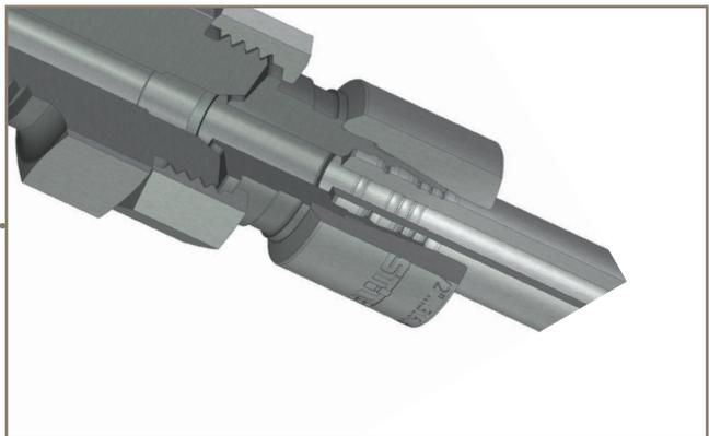
Коническое сопряжение создает герметичное уплотнение с разъемного порта, а правильность сборки гарантируется упорным торцевым сопряжением металл-по-металлу без подсчета оборотов или контроля моментов затяжки.
